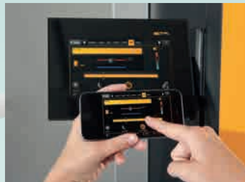
La chaudière se laisse régler par Smartphone, PC ou tablette, voire directement par l'intermédiaire de l'écran tactile.
